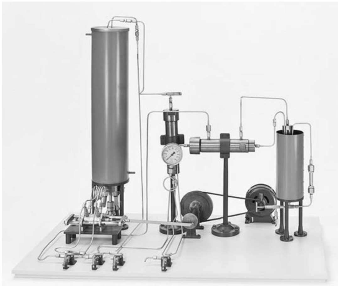
Bild 17 Ammoniaksyntheseapparat von Kirchenbauer & Le Rossignol 1909, hier der Nachbau durch Hermann Lütge von 1930 (DM)
