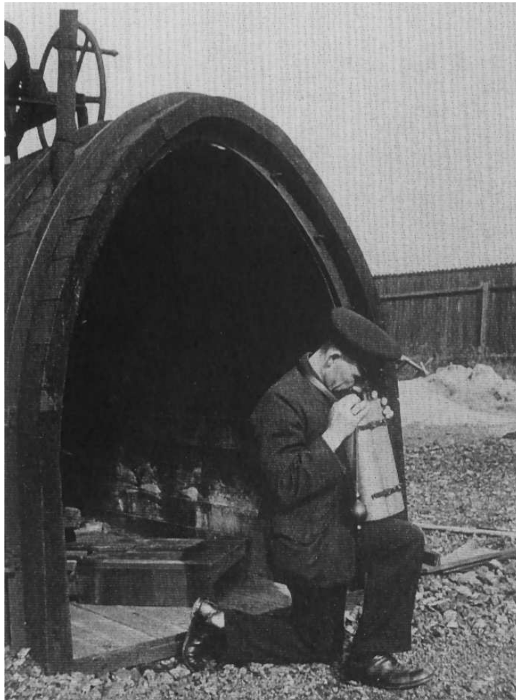
Abb. 12 Grubengasmesser nach Haber 1918, Aus: Stolzenberg 1994,273
