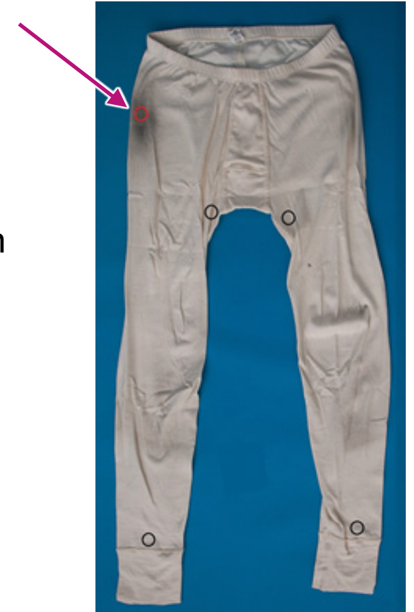
Abbildung: belastete Hose, ○ = Standardstanzposition ○ = Hotspot (Quelle: IPA)
